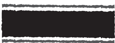
Плохой результат распыления (полосы)
